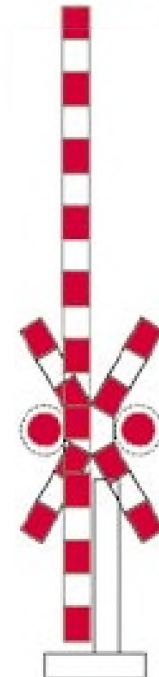
Trecere la nivel cu o cale ferată simplă cu semibarieră, prevăzută cu semnale luminoase de avertizare a apropierii trenului
